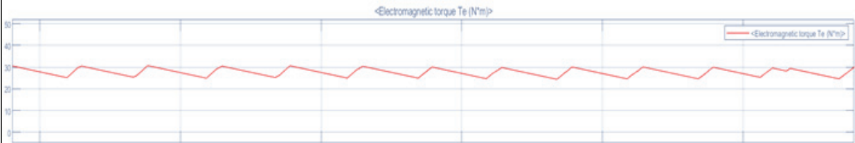
[그림 2] LC필터를 추가하기 전 시뮬레이션 토크 리플
