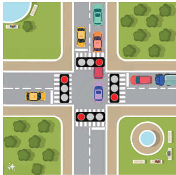
▲ 교차로를 주행 중인 차량들이 있을 때 다음 신호로 바뀌지 않고, 신호를 지연 시켜 사고를 방지한다.
