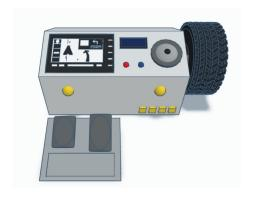
작품은 자동차 페달, 페달 표시등, 내비게이션 화면, 스피커, 비상등, 자동차 바퀴, 스위치로 구성된다. 페달 표시등은 페달 오인 사고를 방지하기 위해 LED를 이용하여 현재 어떤 페달을 밟고 있는지시각적 확인이 가능하게끔 구성하였다. 브레이크를 밟을 때는 브레이크 LED에 불이 들어오고, 액셀을 밟을 때는 액셀 LED에 불이 들어온다. 엔진의 출력은 자동차 바퀴를 통해 나타나게 된다. 윗면의전체적인 구성은 차량의 대시보드 형태와 유사하게 제작하였다.
