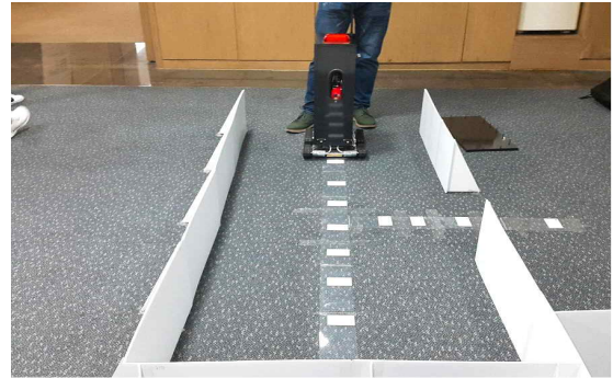
그림 3 RFID 태그를 이용한 위치 인식 방법의 예시 Fig. 3 An example of location recognition method using RFID tags
