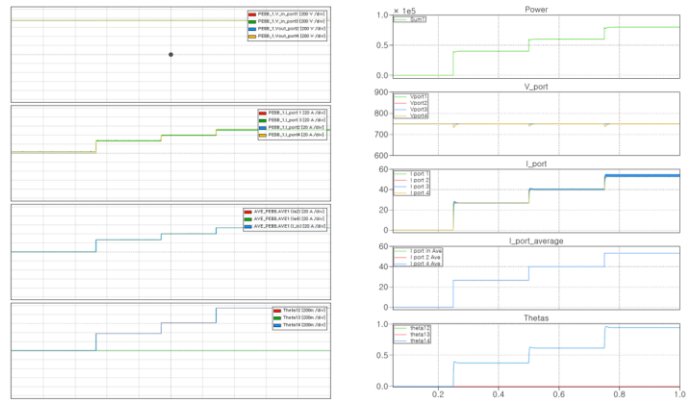
(a) HILS Result (b) PLECS Result 그림4 실시간 시뮬레이션 및 고정 시간 시뮬레이션 결과 비교 Fig.4 Comparison of Real Time and Fixed Time Simulation Result
