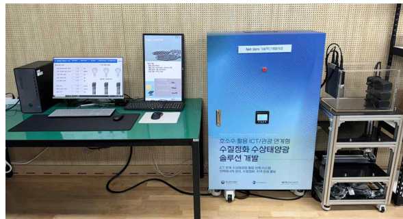
그림 7 직류배전 연계 태양광 기반 축소 모의 제어시스템 Fig. 7 Reduced-scale simulation control system based on DC distribution-linked PV
