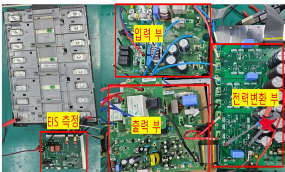
그림 4 EIS-ESS 인버터의 시험 환경 구축 Fig. 4 Experimental setup of EIS-ESS Inverter
