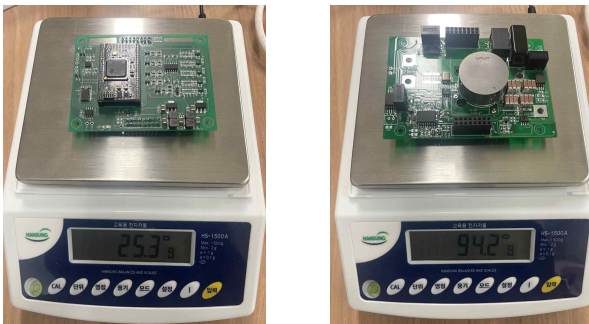
그림 3 무게 측정결과 : (a)전력 회로부, (b)제어부 Fig. 3 Weight Measurement Result: (a)Power board, (b)control board
