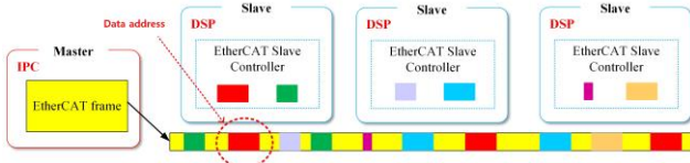
그림3 EtherCAT 통신 기반 계층 구조 Fig.3 Hierarchical structure based on EtherCAT protocol
