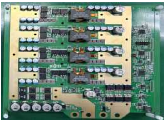
그림 4 제작된 4-Phase Buck Converter 사진 Fig. 4 Produced 4-Phase Buck Converter Photo
