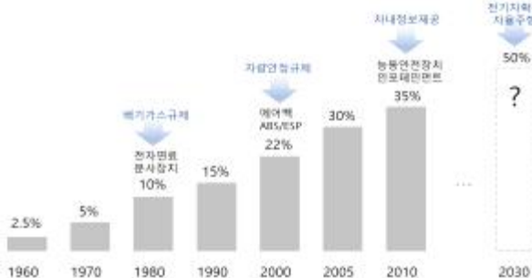
그림 1 차량 내 전장부품 비중 Fig. 1 The proportion of electrical components in the vehicle
