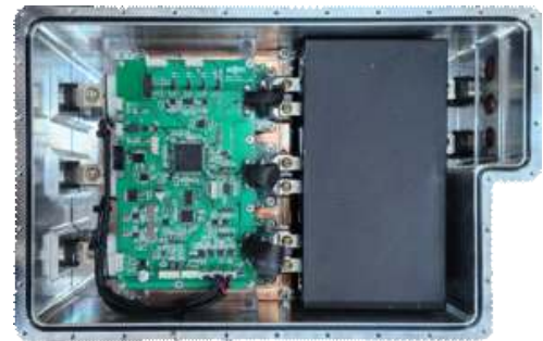
그림 2 비교 시험용 인버터 Fig. 2 The inverter for comparative testing
