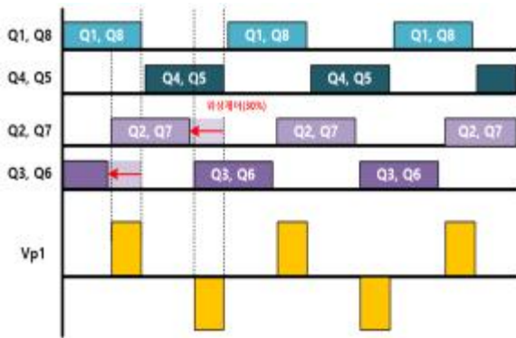
그림 2. NPC 구조의 위상천이 폴-브릿지 컨버터의 동작.
