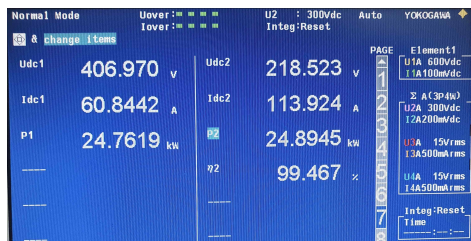
그림 5. 제안하는 FDC의 측정 효율 (Yokogawa WT3000)
