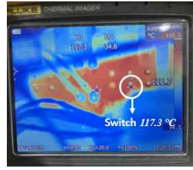
그림 6. 정격 동작 온도 측정 (@ T_{coolant} = 65^\circ C )
