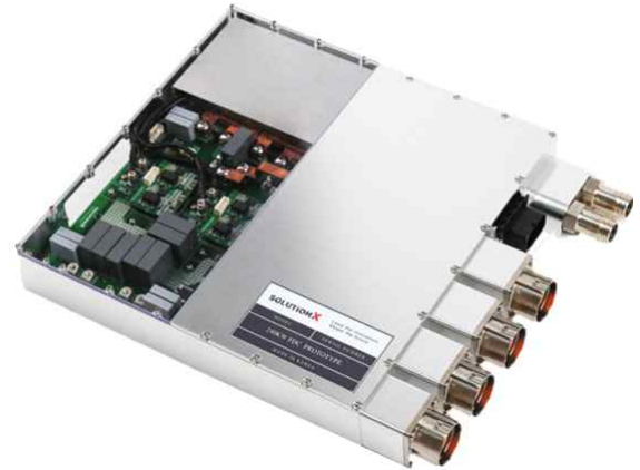
그림 4. 제안하는 240kW FDC 시작품 그림 3은 제안하는 컨버터의 정상 상태에서의 동작 파형이다. 입력 전류와 게이트-소스, 드레인-소스 전압 파형이 포함되어 메인 스위치가 ZVS Turn-on을 성취하는 것을 볼 수 있다. 그림 4는 제안하는 240kW급 FDC의 시작품이다.
