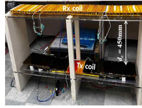
그림 6. 제안하는 무선전력시스템 실험세트 및 주요 파라미터
