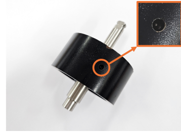
그림 5 인공 결함을 가진 SPM 회전자 Fig. 5 SPM rotor with artificial defect
