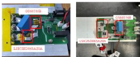
그림2 3kW급 AC/DC 컨버터 하드웨어 (a) 부스트 PFC 컨버터 (b) 토템폴 PFC 컨버터 Fig.2 3kW AC/DC converter (a) Boost PFC converter (b) Totempole PFC converter
