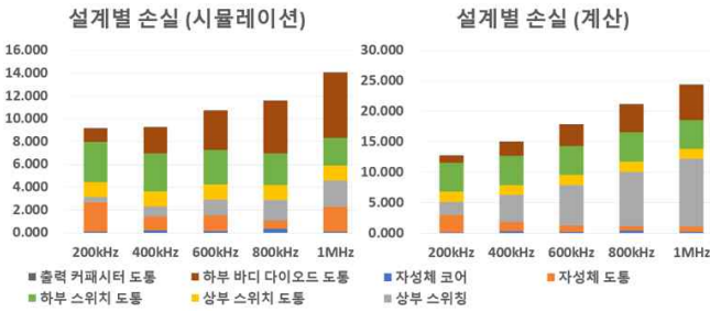
그림 3 주파수에 따른 주요 소자의 시뮬레이션 및 수식 기반 손실
