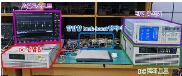
그림 5 배터리 활성화 공정용 GaN 기반 DC/DC 컨버터 testbed Fig. 5 GaN-based DC/DC converter testbed for battery formation
