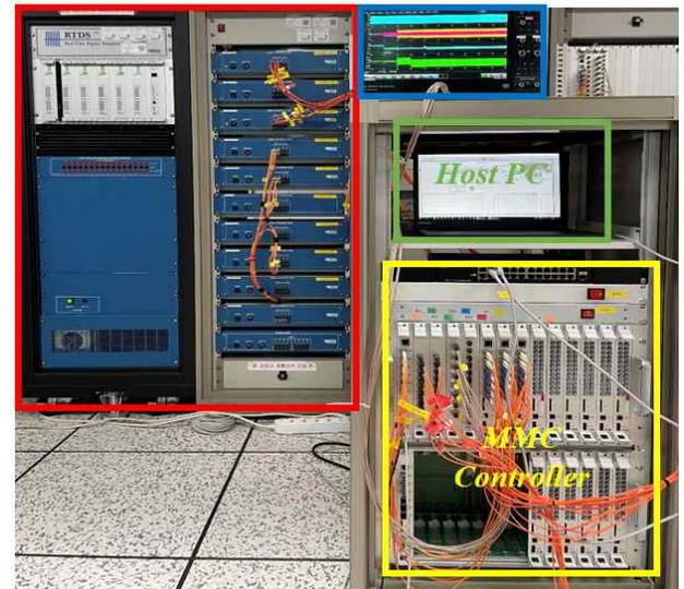
그림 2 FPGA 기반 MMC-STATCOM HILS 구성
