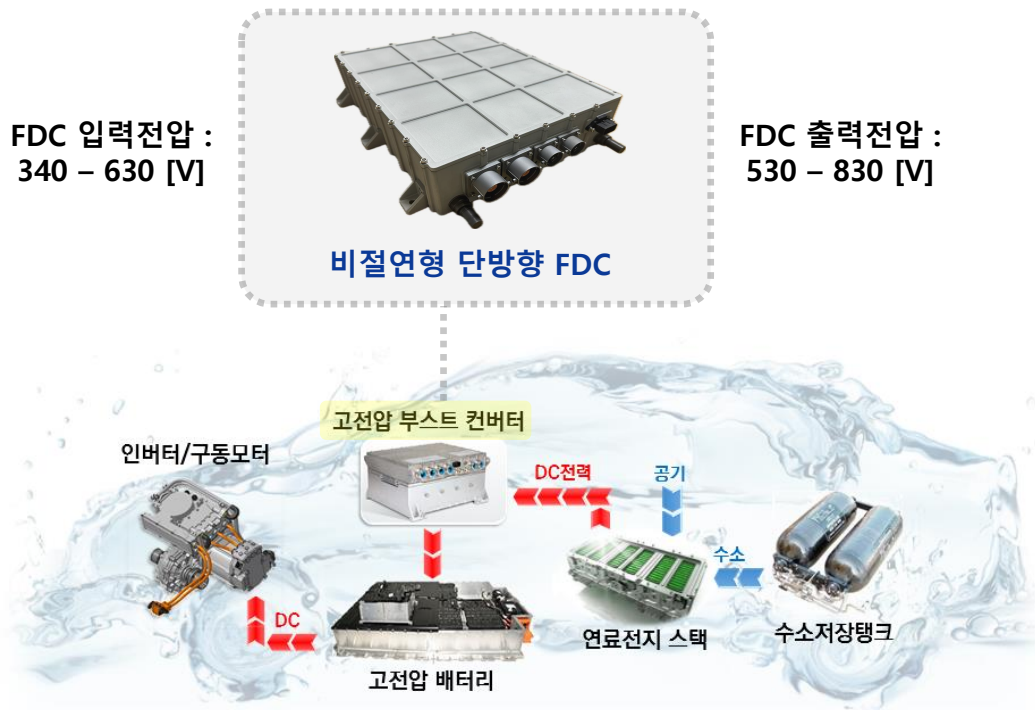
[ 수소 전기차 모터 구동용 전력 시스템 개요도 ]
