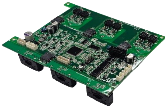
[ 3층 : 게이트 / 컨트롤 / CT 보드 ]
